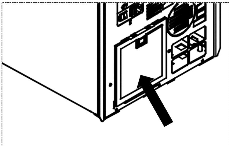
E' un pratico dispositivo che evita la messa in circolazione di polveri sempre presenti in ambienti domestici. Il filtro si trova nella parte posteriore dell'apparecchio. Una frequente pulizia permette di avere maggiore aria calda disponibile durante il funzionamento (il filtro va lavato con acqua fredda e asciugato, ogni 5 giorni).
