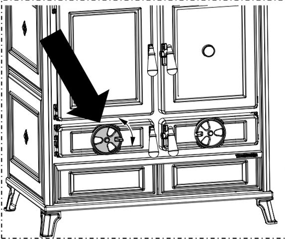
Regola l'afflusso dell'aria primaria. L'aria primaria passando attraverso la griglia del focolare alimenta la combustione determinando così la potenza e la velocità della stessa. Ruotando il regolatore in senso antiorario, si diminuisce l'afflusso dell'aria. Al contrario ruotando il regolatore in senso orario si aumenta l'afflusso dell'aria.
