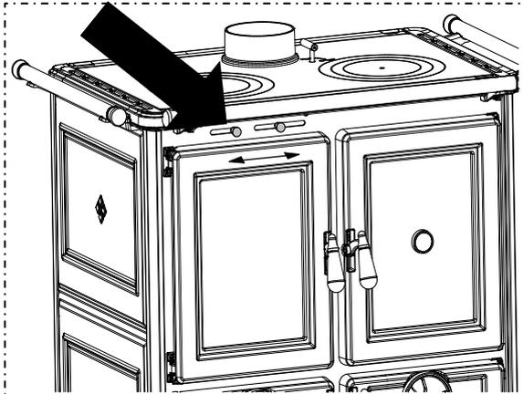
Regola l'afflusso dell'aria secondaria. L'aria secondaria passando attraverso i fori presenti nello schienale della camera di combustione, e quindi preriscaldandosi, favorisce l'innesco della seconda combustione oltre che avere la funzione di mantenere pulito il vetro. Spostando una delle due leve verso sinistra, si diminuisce l'afflusso dell'aria. Al contrario spostandola verso destra si aumenta l'afflusso dell'aria.
