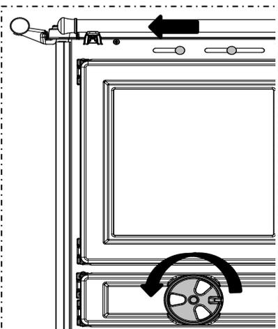
L'apparecchio è a combustione intermittente e quindi sarà necessario alimentarlo con ricariche di legna. Una volta accertata la piena combustione all'interno della camera di combustione e quindi la presenza di braci procedere ad effettuare la prima carica procedendo come segue:
