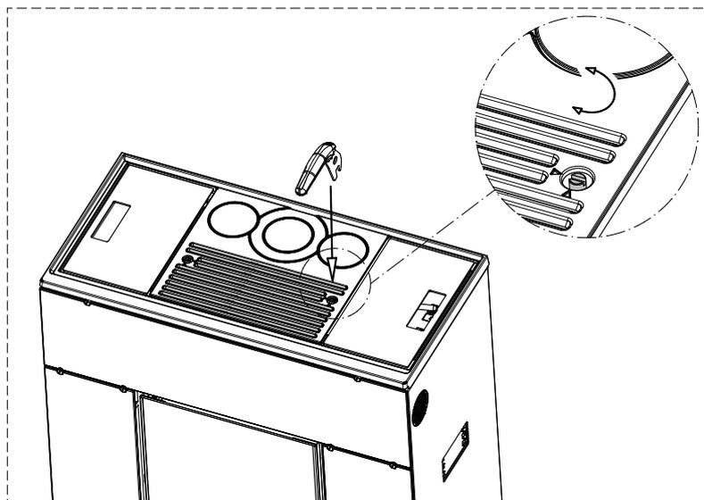
E' possibile scegliere se direzionare il flusso dell'aria nella canalizzazione laterale o posteriore/superiore girando la leva indicata nella figura sopra. Il flusso uscirà nel verso indicato dalla freccia.
