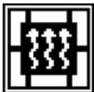
Visualizza l'esclusione della ventilazione, ovvero il ventilatore ambiente è disabilitato. Tuttavia, qualora il corpo stufa salisse di temperatura, il ventilatore si attiverà forzatamente e aumenterà la potenza di ventilazione all'aumentare di tale temperatura, visibile dalle barrette accese attorno al simbolo. Una volta scesa sotto una certa soglia il ventilatore ambiente si disattiverà automaticamente.
