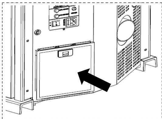
Il s'agit d'un dispositif pratique qui permet d'éviter la mise en circulation de poussières toujours présentes dans les milieux domestiques. Le filtre est installé à l'arrière de l'appareil. Un nettoyage fréquent permet d'avoir plus d'air chaud à disposition durant le fonctionnement (le filtre doit être lavé à l'eau froide et séché, tous les 5 jours).
