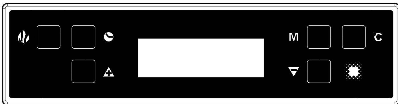
Le tableau de commande est géré par un microprocesseur. Le système de détection de température est confié à des thermocouples. Le grand écran améliore la gestion de l'appareil en rendant la lecture et les fonctions disponibles immédiatement. La fonction principale du panneau est de gérer l'appareil de façon entièrement automatique. Les commandes et les différents affichages sont décrits ci-dessous.
