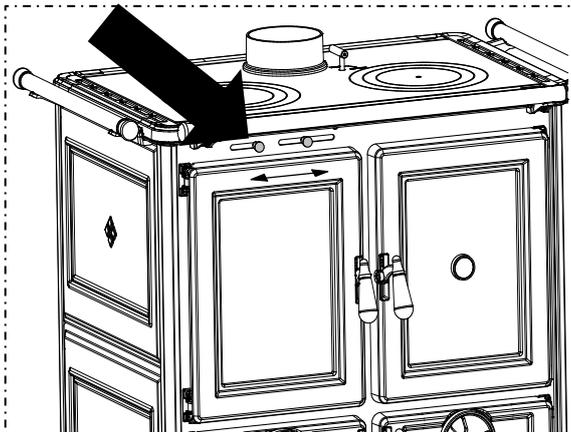
Gère l'arrivée de l'air secondaire. L'air secondaire en passant par les orifices présents au dos de la chambre de combustion, et donc en préchauffant, favorise l'amorçage de la deuxième combustion et a aussi pour fonction de maintenir la vitre propre. En déplaçant l'un des deux leviers vers la gauche, on diminue l'arrivée de l'air. En le déplaçant à l'inverse vers la droite on augmente l'arrivée de l'air.
