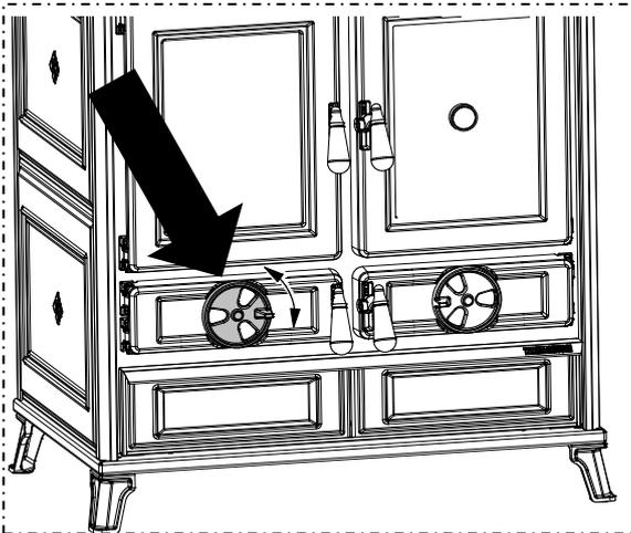
Gère l'arrivée d'air primaire. L'air primaire en passant par la grille du foyer alimente la combustion en gérant ainsi la puissance et la vitesse de cette dernière. En tournant le régulateur dans le sens inverse des aiguilles d'une montre, on diminue l'arrivée de l'air. En tournant en revanche le régulateur dans le sens des aiguilles d'une montre on augmente l'arrivée de l'air.
