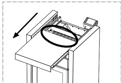
Pousser d'une main l'arrière du couvercle du réservoir.
