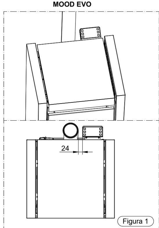
Si, pour des raisons esthétiques, le panneau de commande doit être placé dans une position centrale, il peut être déplacé en suivant les instructions ci-dessous :
