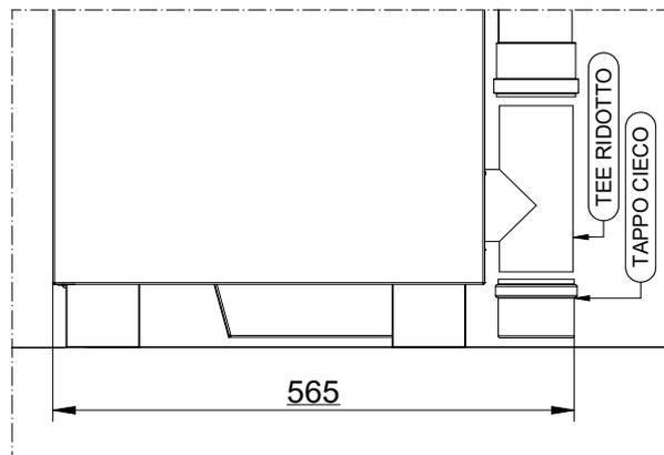
L'appareil est fourni avec le tableau de commande monté sur le générateur : dans ce cas, le raccordement au carneau doit être effectué comme indiqué sur la figure 1. Faire très attention lors du montage du tuyau de sortie des fumées car celui-ci doit respecter une distance d'au moins 24 mm par rapport au tableau de commande (Figure 1) : le montage du tuyau trop près du tableau endommagerait le tableau de commande (dommages non couverts par la garantie).
