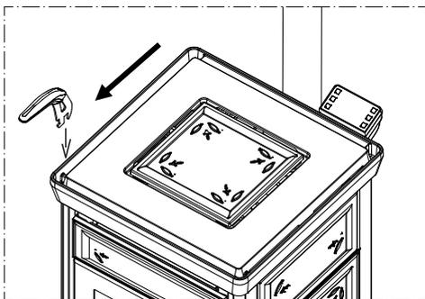
Extraire le couvercle du réservoir en utilisant la poignée appropriée fournie.
