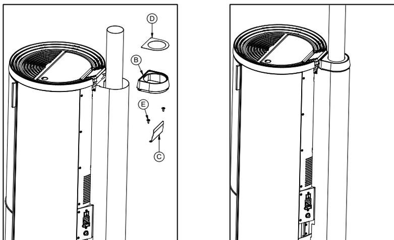
4) Fixer le support (C) avec les deux vis (E), ensuite insérer la céramique (B) et le profil esthétique (D).
