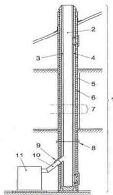
Chaque cheminée doit être composée au minimum des composants prévus par la norme UNI EN 1443, et indiqués dans la figure à gauche.
