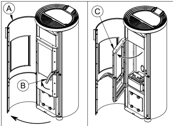
Pour ouvrir et fermer la porte du foyer (C) ouvrir la porte extérieure (A) et déverrouiller le crochet à l'aide de la poignée prévue (B). Après avoir conclu cette opération, il est recommandé de retirer la poignée pour éviter toute ouverture accidentelle de la porte. N'ouvrir la porte que pour les opérations de nettoyage et impérativement lorsque l'appareil est froid et débranché de la prise de courant.
