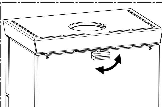
Il retient la chaleur à l'intérieur de l'échangeur à la fin de la charge et limite la dissipation de la chaleur par le carneau. Le régulateur s'ouvre en tournant le levier en position verticale (12 heures) et se ferme en tournant le levier en position horizontale.
