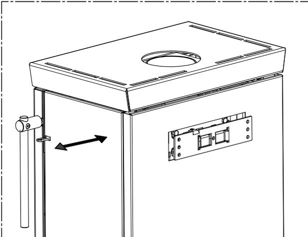
Gère l'arrivée de l'air secondaire qui, en passant par les orifices présents au dos de la chambre de combustion, et donc en préchauffant, favorise l'amorçage de la deuxième combustion. En déplaçant le régulateur vers l'extérieur, le débit d'air diminue. En le déplaçant vers l'intérieur, le débit d'air augmente.
