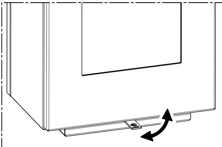
Gère l'arrivée d'air primaire. L'air primaire, en passant par la grille du foyer, alimente la combustion, gérant ainsi la puissance et la vitesse de cette dernière. En déplaçant le régulateur vers la gauche, le débit d'air diminue. En déplaçant le régulateur vers la droite, le débit d'air augmente.
