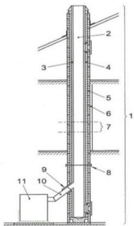
Chaque cheminée doit être composée au minimum des composants prévus par la norme UNI EN 1443, et indiqués dans la figure ci-contre.
