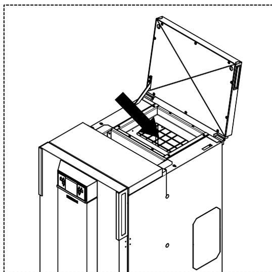
**N'introduire dans le réservoir que des granulés conformes aux spécifications indiquées ci-dessus ; n'introduire en aucun cas des substances ou des corps étrangers dans le réservoir, le brasero et dans aucun compartiment du générateur.**
