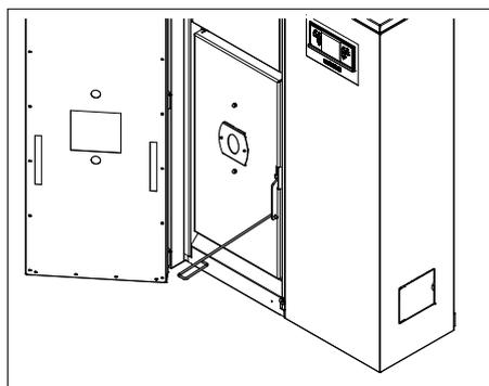
L'appareil est muni d'une poignée d'ouverture et fermeture de la porte du foyer pour permettre les opérations de nettoyage (voir paragraphe spécifique). Pour ouvrir la porte utiliser le tisonnier fourni comme indiqué sur la figure.
