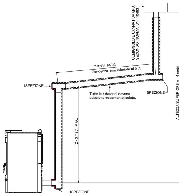
Toutes les parties du conduit des fumées devront pouvoir être vérifiées et démontées pour effectuer le nettoyage interne.
