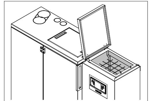
**N'introduire dans le réservoir que des granulés conformes aux spécifications indiquées ci-dessus ; n'introduire en aucun cas des substances ou des corps étrangers dans le réservoir, le brasero et dans aucun compartiment du générateur.**
