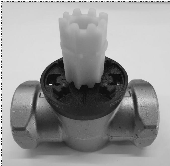
**1** - Insérez la pièce dentée dans le corps de la vanne jusqu'à la fin de la course. Pour ce faire, insérez-la par le côté le plus long comme indiqué sur l'image ci-dessus.
