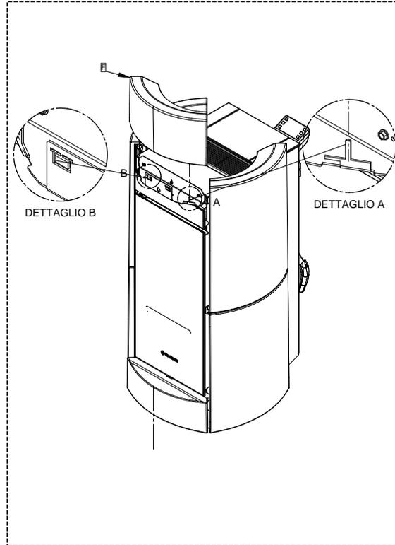
8 - Insérer la faïence supérieure (F) dans les dents appropriées. Déformer légèrement les dents pour que la faïence soit bien fixée au corps.
