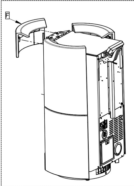
7 - Insérer la faïence supérieure (F) dans les dents appropriées. Déformer légèrement les dents pour que la faïence soit bien fixée au corps.
