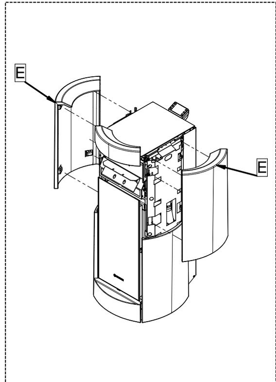
5 - Insérer le côté supérieur (E) dans les dents appropriées, en répétant la procédure précédemment effectuée. Déformer légèrement les dents pour que la faïence soit bien fixée au corps. Effectuer la même procédure du côté opposé.
