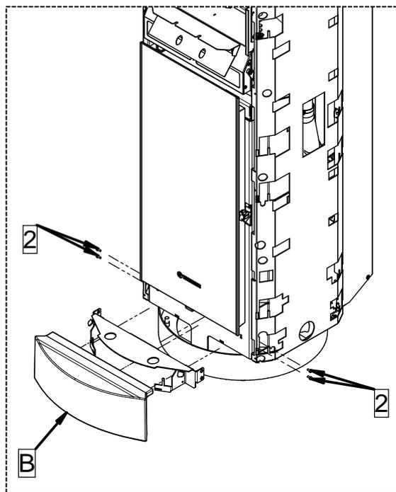
1 - Dévisser les 4 vis (2) et retirer le support de la faïence. Insérer la faïence inférieure (B) dans le support qui vient d'être enlevé. Enfin, refixer le support complet de faïence à l'aide des 4 vis (2) qui viennent d'être retirées.
