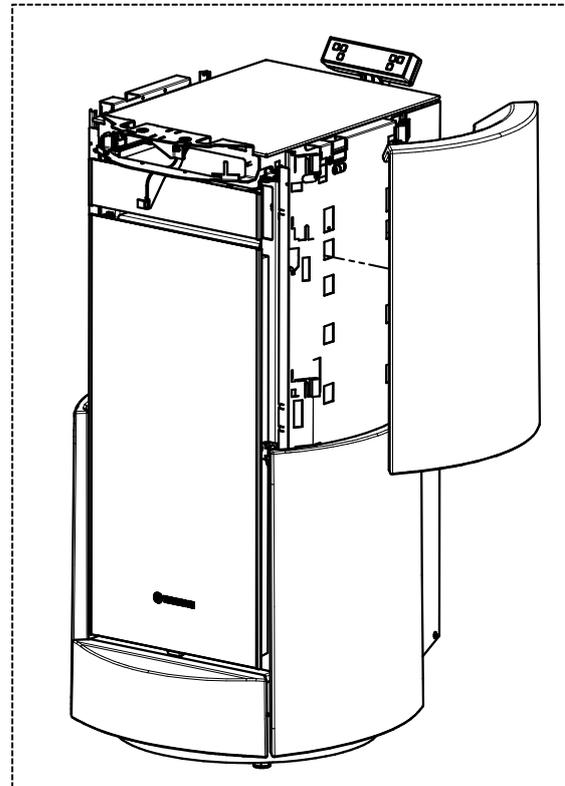
6 - Insérer le côté supérieur (C) dans les dents appropriées, en répétant la procédure précédemment effectuée. Déformer légèrement les dents pour que la faïence soit bien fixée au corps. Effectuer la même procédure du côté opposé.
