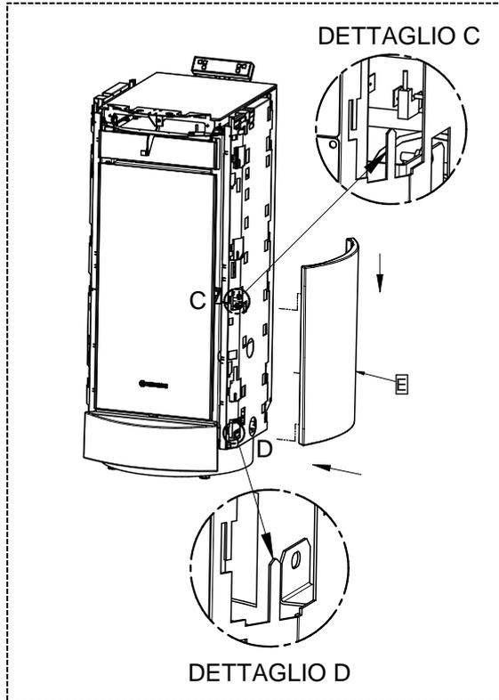
5 - Insérer le côté inférieur (E) dans les dents appropriées (voir les détails C et D). Déformer légèrement les dents pour que la faïence soit bien fixée au corps. Effectuer la même procédure du côté opposé.
