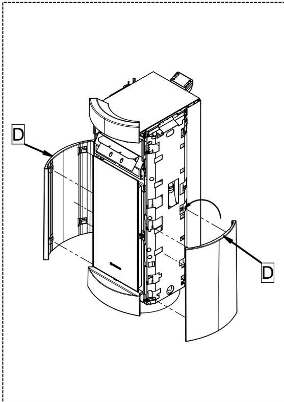
4 - Insérer le côté inférieur (D) dans les dents appropriées. Déformer légèrement les dents pour que la faïence soit bien fixée au corps. Effectuer la même procédure du côté opposé.
