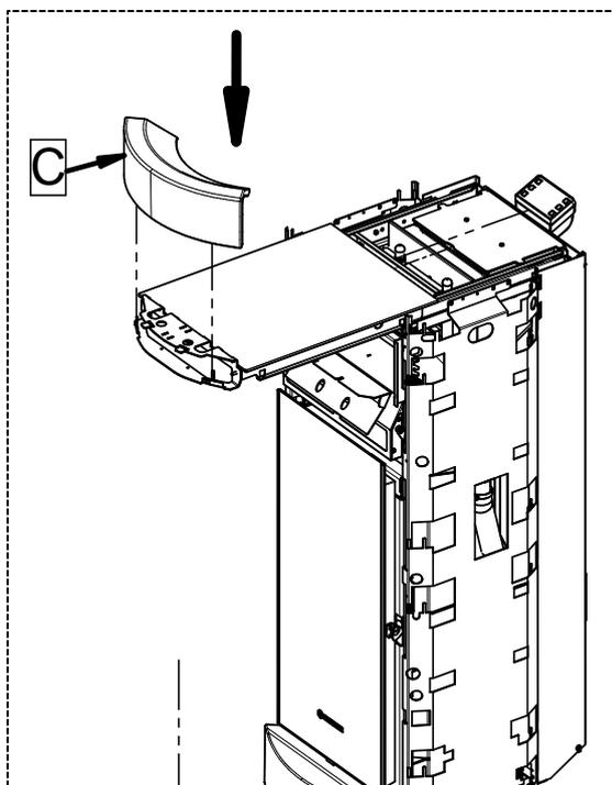
2 - Extraire le plateau et insérer la faïence supérieure (C) dans les dents appropriées. Déformer légèrement les dents pour que la faïence soit bien fixée au corps.
