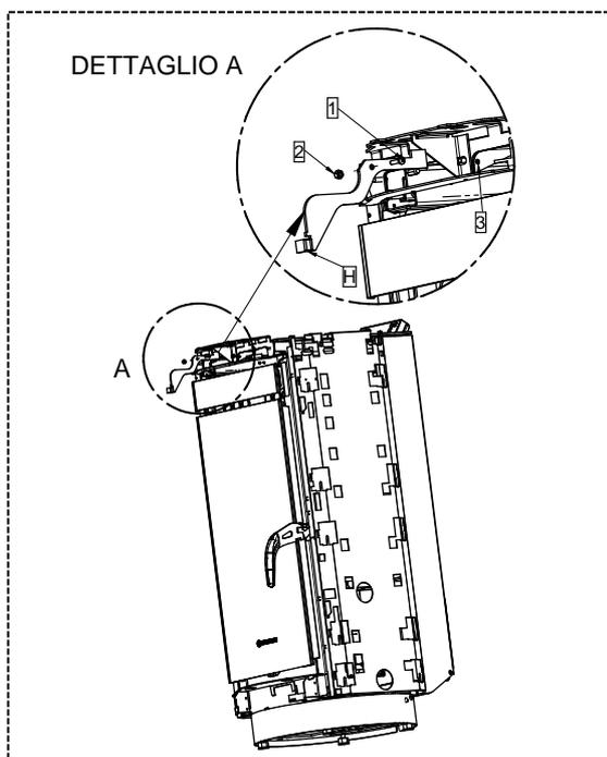
1 - Fixer le support (H) au trou (3) au moyen de la vis (1) et de l'écrou (2).
