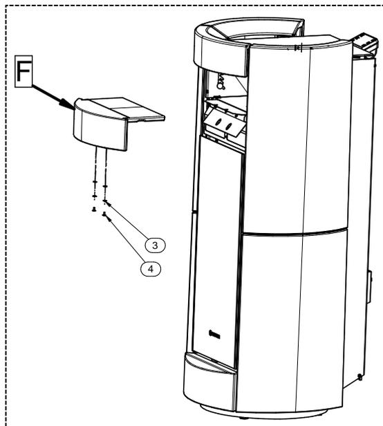
6 - Pour les appareils à air uniquement, insérer la faïence centrale (F) comme indiqué sur la figure. La fixer ensuite avec les vis (4) et les rondelles (3).
