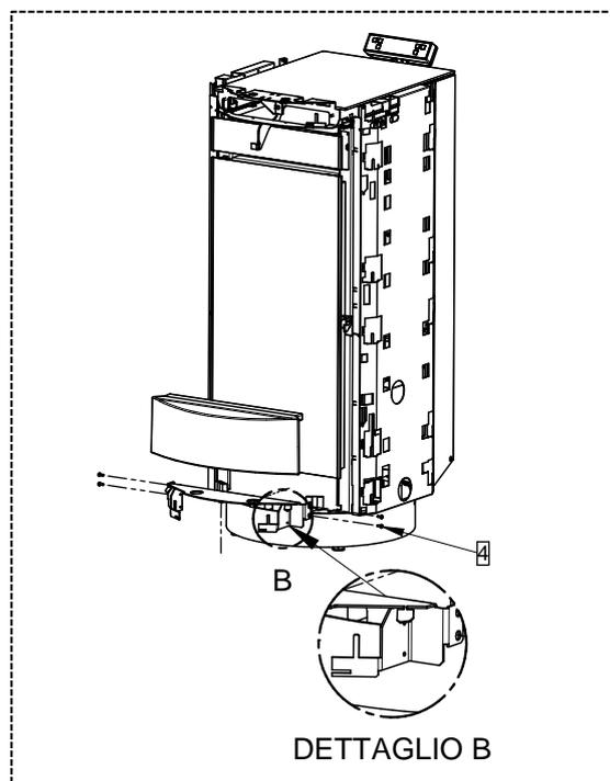
4 - Régler les deux dents mentionnées au DÉTAIL B de façon à ce que la faïence soit fermement fixée au support. Enfin, refixer le support complet de faïence à l'aide des 4 vis (4) préalablement retirées.
