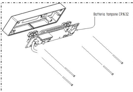
Innerhalb des Bedienfeldes befindet sich eine Pufferbatterie des Typs CR1632. Wenn die Uhrzeit und die Programmierung nicht gespeichert bleiben (diese Fehlfunktion gilt nicht als Defekt, weil sie auf normalem Verschleiß oder Verbrauch beruht), ist der Wechsel der Batterie fällig. Dazu die vier Schrauben auf der Rückseite des Bedienfeldes entfernen. Die Altbatterie muss nach ihrer Entfernung auf sichere Weise entsorgt werden.
