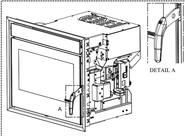
Ihr Gerät verfügt über einen abnehmbaren Griff, mit dem sich die Feuerraumtür zwecks Reinigung öffnen und schließen lässt (siehe den entsprechenden Abschnitt). Es wird empfohlen, danach den Griff zu entfernen, um ein versehentliches Öffnen der Tür auszuschließen.
