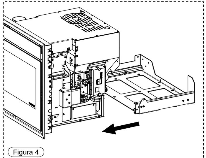
3) Die Feuerraumtür öffnen und durch Drücken des Hebels nach unten das System entsperren, das vor dem Herausziehen sichert. Benutzen Sie dazu den entsprechenden Griff.
