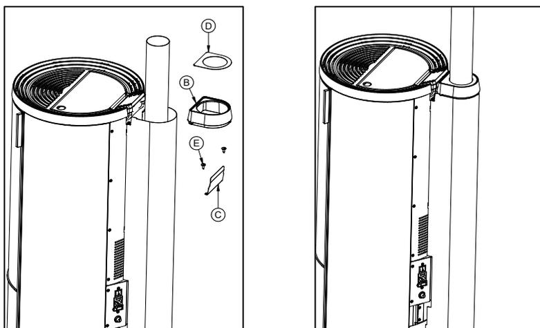
4) Den Bügel (C) mit den beiden Schrauben (E) befestigen, dann die Keramik (B) und das Verblendungsprofil (D) einsetzen.
