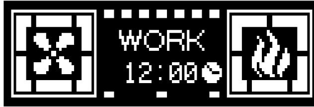
Anzeige der eingestellten **Verbrennungsleistung** und somit des Pelletverbrauchs durch das Aufleuchten der Balken um das Flammensymbol. Die Logik ist wie folgt:
