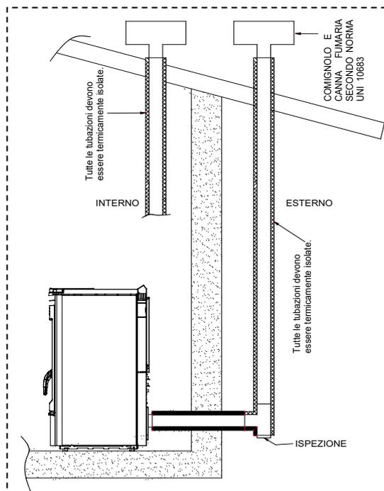
DER RAUCHKANAL DARF AUSSCHLIESSLICH VOM GERÄT GENUTZT WERDEN.
