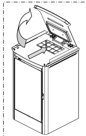
**Der Pelletbehälter darf ausschließlich mit Pellets befüllt werden, die den obigen Anforderungen genügen. Keinesfalls dürfen andere Stoffe oder Fremdkörper in den Behälter, den Brenntopf und andere Bereich des Wärmereizgers eingeführt werden.**
