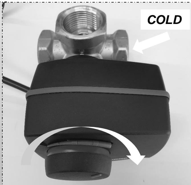
**7** – Den herausgezogenen Verschluss bis zum Anschlag gegen den Uhrzeigersinn drehen, um sicherzustellen, dass der Einbau erfolgreich war. Ist der HOT-Zweig vollständig geschlossen, war der Einbau erfolgreich, andernfalls sind die Abläufe wieder von Neuem vorzunehmen.
