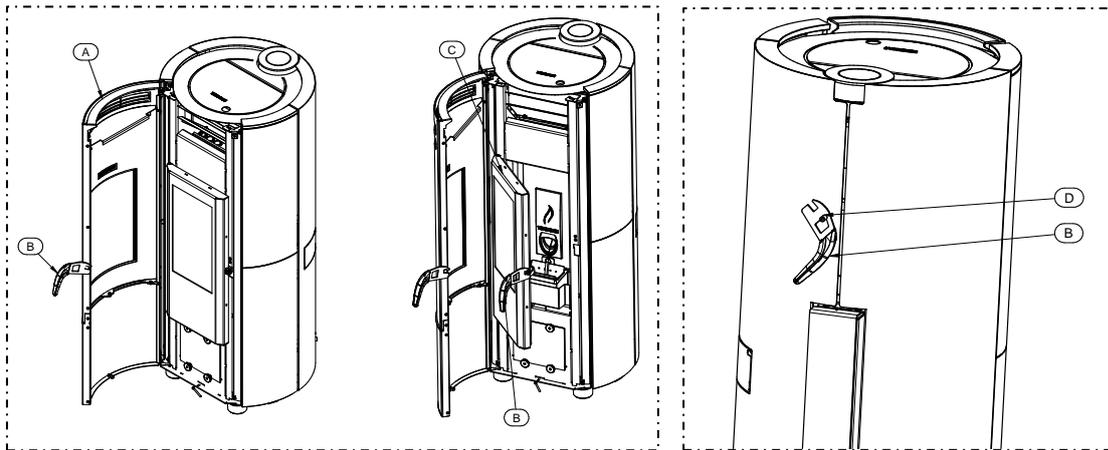
Zum Öffnen oder Schließen der Feuerraumtür (C) die Außentür (A) mit dem zugehörigen Griff (B) öffnen und dann den Haltehaken ebenfalls mit dem Griff (B) entsperren.
