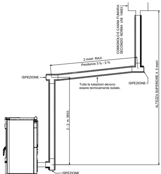
sachgerecht abdichten. Es ist strikt untersagt, am Ende des Abzugsrohres ein Netz anzubringen, weil dadurch der Betrieb des Geräts beeinträchtigt werden könnte.
