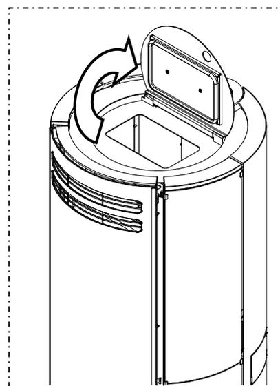
**Der Pelletbehälter darf ausschließlich mit Pellets befüllt werden, die den obigen Anforderungen genügen. Keinesfalls dürfen andere Stoffe oder Fremdkörper in den Behälter, den Brenntopf und andere Bereich des Wärmegerätes eingeführt werden.**
