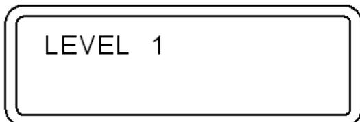
2) Zur Änderung der Betriebsstufe eine **Rollen-Taste** gedrückt halten und gleichzeitig die andere **Rollen-Taste** drücken.
