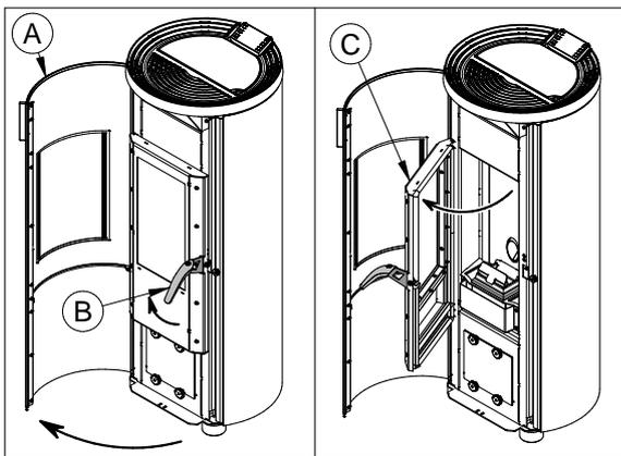
Zum Öffnen oder Schließen der Feuerraumtür (C) die Außentür (A) öffnen und mit dem zugehörigen Griff (B) den Haltehaken entsperren. Es wird empfohlen, danach den Griff zu entfernen, um ein versehentliches Öffnen der Tür auszuschließen. Die Tür darf nur bei erkaltetem und von der Stromversorgung getrenntem Gerät zur Reinigung geöffnet werden.
