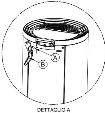
Ihr Gerät ist mit einem Griff (B) ausgestattet, mit dem sich die Feuerraumtür zur Reinigung öffnen und schließen lässt. Wenn er nicht verwendet wird, kann der Griff auf der Rückseite des Gerätes untergebracht werden.
