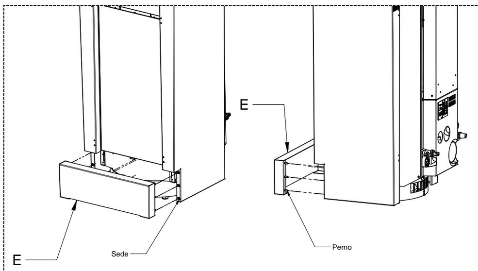
6 – Das untere Profil (E) montieren, indem man die Stifte in den zugehörigen Aufnahmen einrasten lässt. Es wird empfohlen, zunächst die 3 Stifte einer Seite einrasten zu lassen, dann die 3 Stifte der anderen Seite.
