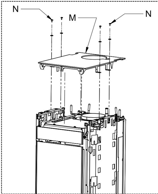
1 – Die obere Arbeitsplatte (M) durch Ausdrehen der 4 Schrauben (N) ausbauen.
