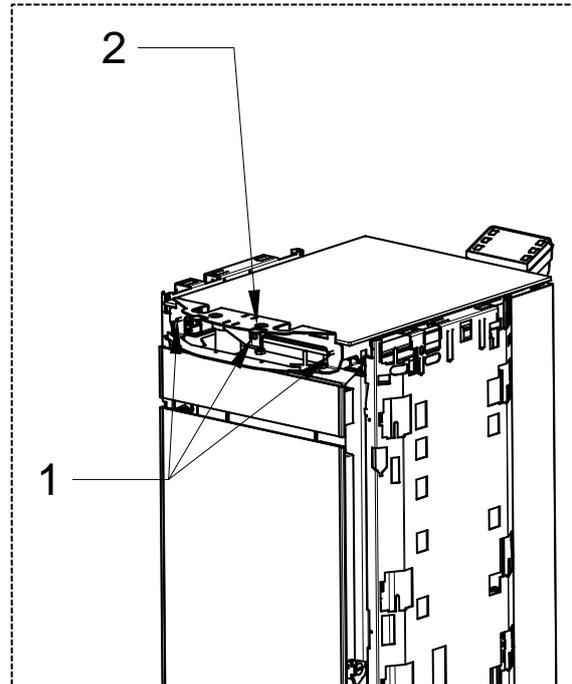
2 – Die 3 Schrauben (1) entfernen, die den Frontbügel (2) festhalten. Den Bügel (2) entnehmen.
