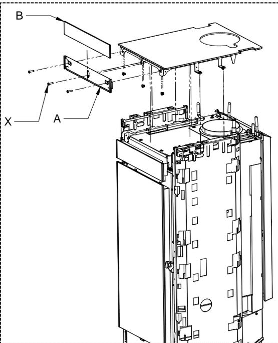
3 - Die Halterung der kleinen Glasscheibe (A) mit den zum Bausatz gehörenden Schrauben (X) am Produkt befestigen. Dann die kleine Glasscheibe (B) in die Halterung für kleine Glasscheibe (A) einführen. Nun die obere Arbeitsplatte (M) wieder einbauen.
