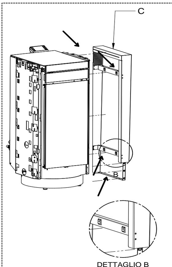
6 – Die Seitenwand (C) montieren, indem man die Flügel (DETTAIL B) in die entsprechenden Aufnahmen einführt. Es wird empfohlen, die Flügel um 1 bis 2 mm zu verbreitern.
