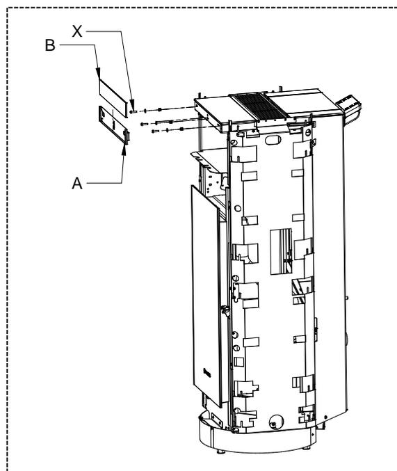
2 - Die Halterung der kleinen Glasscheibe (A) mit den zum Bausatz gehörenden Schrauben (X) am Produkt befestigen. Dann die kleine Glasscheibe (B) in die Halterung für kleine Glasscheibe (A) einführen.
