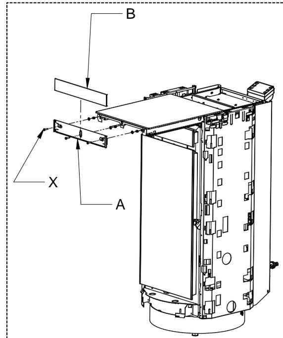
4 - Die Halterung der kleinen Glasscheibe (A) mit den zum Bausatz gehörenden Schrauben (X) am Produkt befestigen. Dann die kleine Glasscheibe (B) in die Halterung für kleine Glasscheibe (A) einführen.
