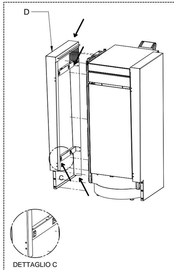
7 – Die Seitenwand (D) montieren, indem man die Flügel (DETTAIL C) in die entsprechenden Aufnahmen einführt. Es wird empfohlen, die Flügel um 1 bis 2 mm zu verbreitern.
