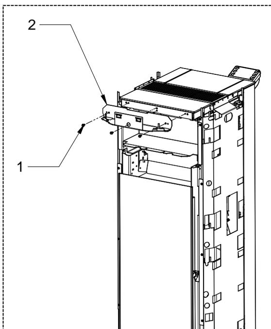
1 – Die 3 Schrauben (1) entfernen, die den Frontbügel (2) festhalten. Den Bügel (2) entnehmen.
