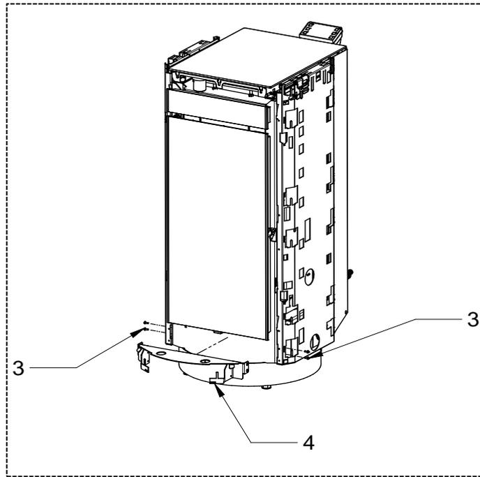
5 – Den unteren Bügel (4) durch Ausdrehen der vier Schrauben (3) ausbauen. Den unteren Bügel (4) entnehmen.
