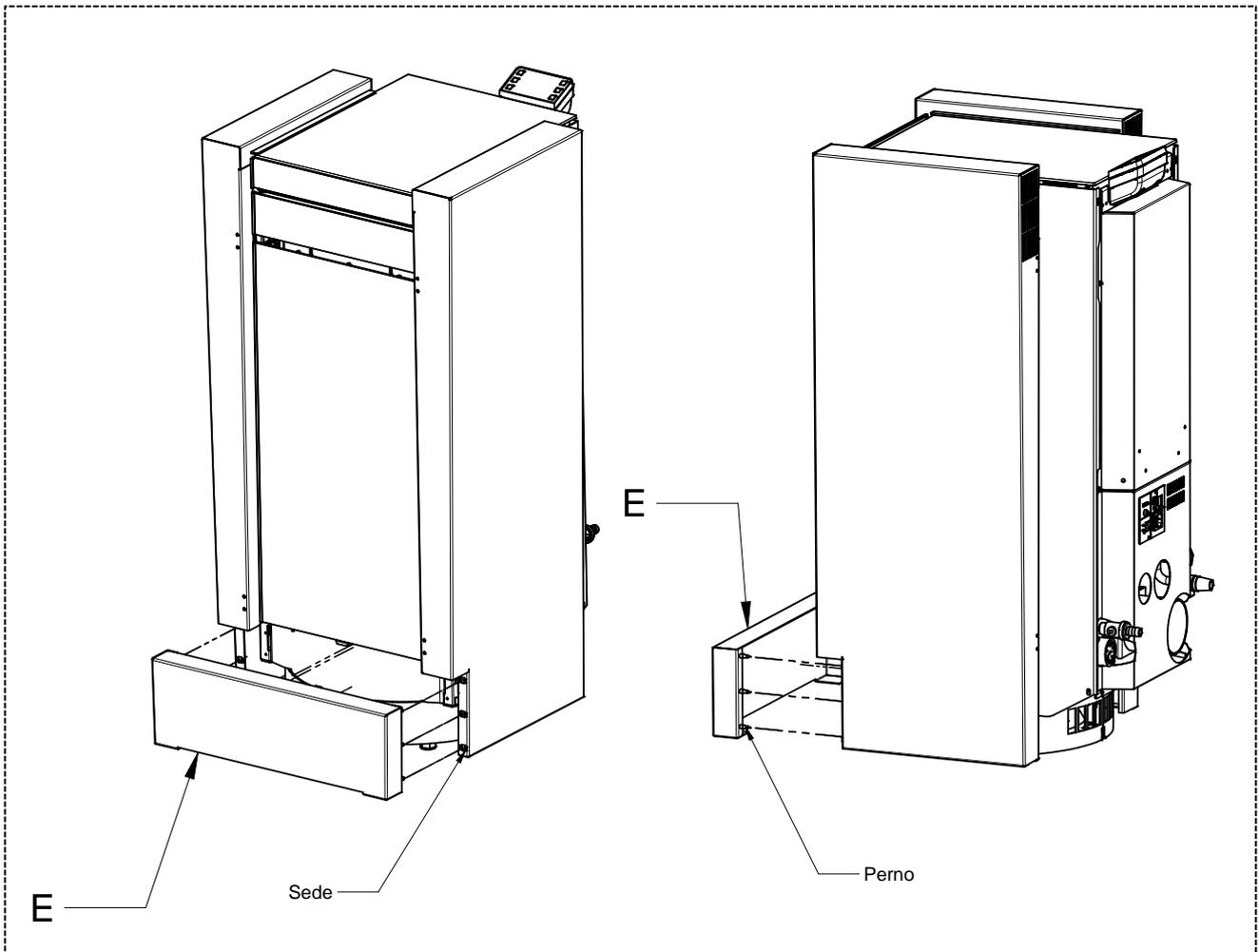
8 – Das untere Profil (E) montieren, indem man die Stifte in den zugehörigen Aufnahmen einrasten lässt. Es wird empfohlen, zunächst die 3 Stifte einer Seite einrasten zu lassen, dann die 3 Stifte der anderen Seite.
