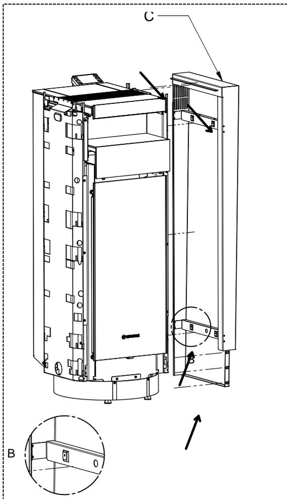
4 – Die Seitenwand (C) montieren, indem man die Flügel (DETAIL B) in die entsprechenden Aufnahmen einführt. Es wird empfohlen, die Flügel um 1 bis 2 mm zu verbreitern.
