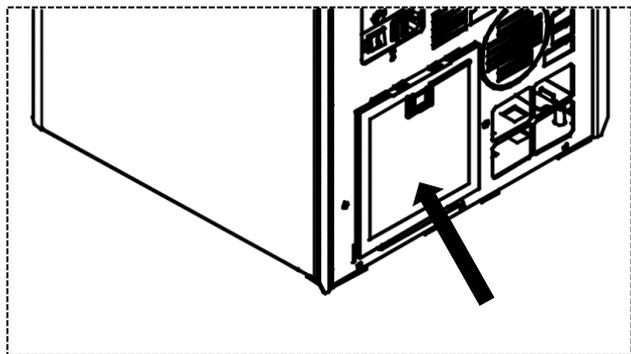
Es un práctico dispositivo que evita la puesta en circulación del polvo que hay siempre en los ambientes domésticos. El filtro se encuentra en la parte posterior del equipo. Una frecuente limpieza permite disponer de más aire caliente durante el funcionamiento (el filtro debe limpiarse con agua fría y secarse cada 5 días).
