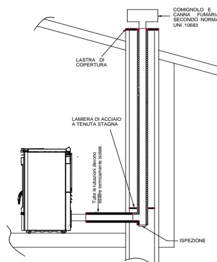
Todos los tramos del conducto de humos se deberán poder inspeccionar y desmontar para posibilitar la limpieza interior.
