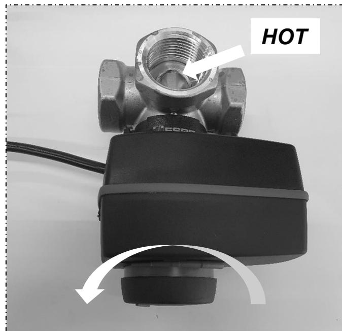
**7** - Para verificar si la instalación se ha realizado correctamente, gire el tapón extraído en sentido levógiro hasta el final de carrera. Si la rama HOT está completamente cerrada, la instalación se ha realizado correctamente; en caso contrario, se recomienda repetir el procedimiento desde el principio.
