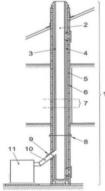
Cada chimenea debe estar compuesta al menos por los componentes previstos por la norma UNI EN 1443, indicados también en la figura de la izquierda.
