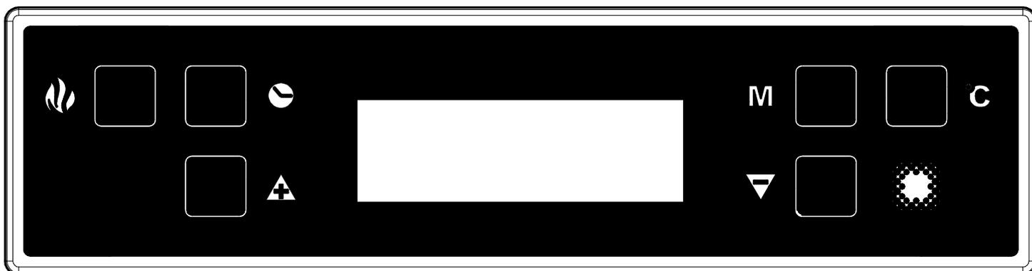
El panel de mandos es controlado por un microprocesador. El sistema de detección de las temperaturas se basa en termopares. El visualizador, de grandes dimensiones, mejora la gestión del equipo facilitando la lectura inmediata y la disponibilidad de las funciones. La característica principal del panel es la de gestionar de manera totalmente automática el equipo. A continuación se describen los mandos y las diferentes visualizaciones.
