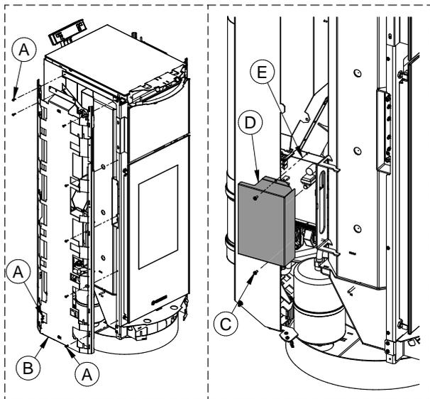
Para acceder a la tarjeta electrónica, siga las indicaciones de las figuras anteriores:
