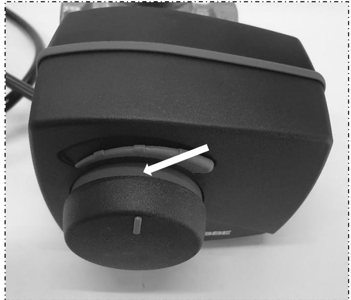
**6** - Introduzca el tapón extraído hasta el final de carrera, empujándolo hacia el motor. A continuación, tire del tapón hacia afuera hasta que se perciba un clic y se vea la banda de color rojo (véase la fotografía anterior).
