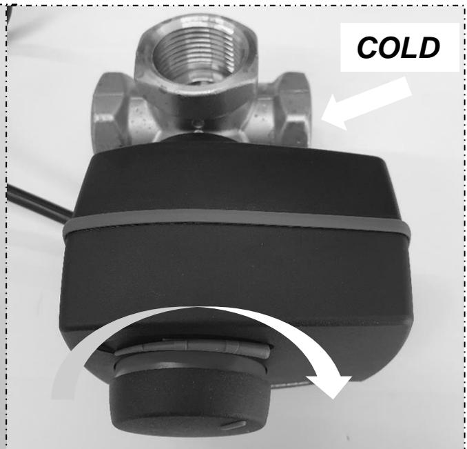
**8** - Para verificar si la instalación se ha realizado correctamente, gire el tapón extraído en sentido dextrógiro hasta el final de carrera. Si la rama COLD está completamente cerrada, la instalación se ha realizado correctamente; en caso contrario, se recomienda repetir el procedimiento desde el principio. Por último, presione el tapón hacia adentro, hasta hacer desaparecer la banda de color rojo.
