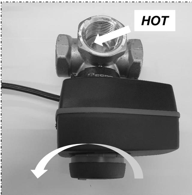
**7** - Para verificar si la instalación se ha realizado correctamente, gire el tapón extraído en sentido levógiro hasta el final de carrera. Si la rama HOT está completamente cerrada, la instalación se ha realizado correctamente; en caso contrario, se recomienda repetir el procedimiento desde el principio.
