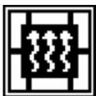
Visualiza la exclusión de la ventilación (ventilador ambiente inhabilitado). Sin embargo, si aumenta la temperatura del cuerpo de la estufa, el ventilador se activa en forma forzada y la potencia de ventilación aumenta con el aumento de dicha temperatura, visible mediante las barras encendidas alrededor del símbolo. Una vez que la temperatura desciende por debajo de un cierto umbral, el ventilador ambiente se desactiva automáticamente.
