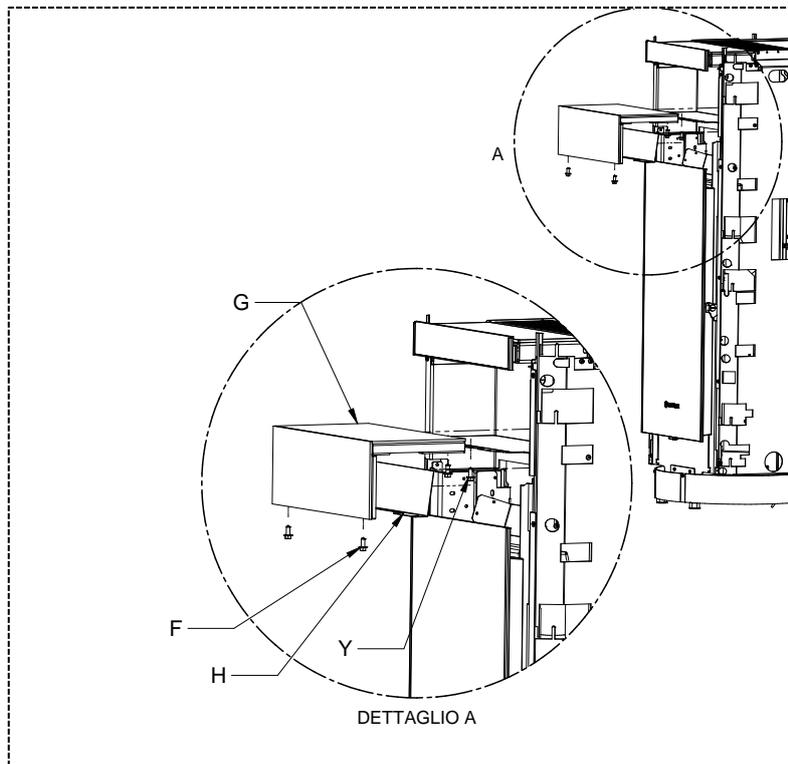
3 – Fije el deflector de aire (H) al calentaplatos (G) con los tornillos (F). A continuación, fíjelo al aparato con los tornillos (Y). ver detalle A
