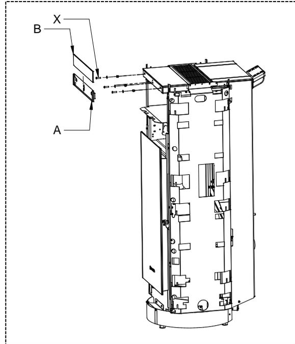
2 – Fije el soporte del cristal (A) al equipo con los tornillos (X) suministrados en el kit. Luego, introduzca el cristal (B) en el soporte del cristal (A).
