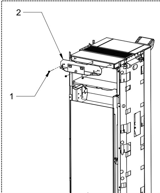
1 – Desenrosque los 3 tornillos (1) que fijan el soporte delantero (2). Eliminar el soporte (2).
