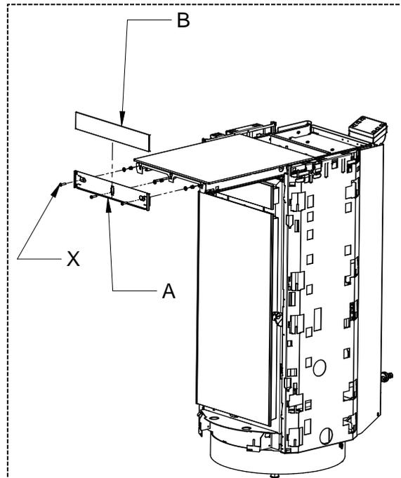
4 – Fije el soporte del cristal (A) al equipo con los tornillos (X) suministrados en el kit. Luego, introduzca el cristal (B) en el soporte del cristal (A).
