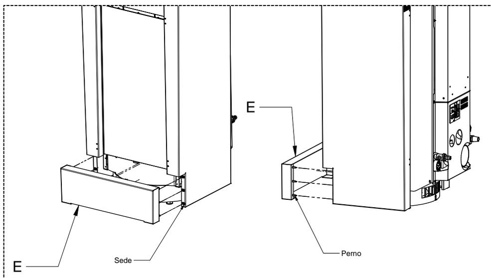
6 – Monte el perfil inferior (E) encajando las clavijas (Perno) en los alojamientos (Sede) correspondientes. Se aconseja encajar primero las 3 clavijas de un lado, y después las 3 clavijas del otro lado.
