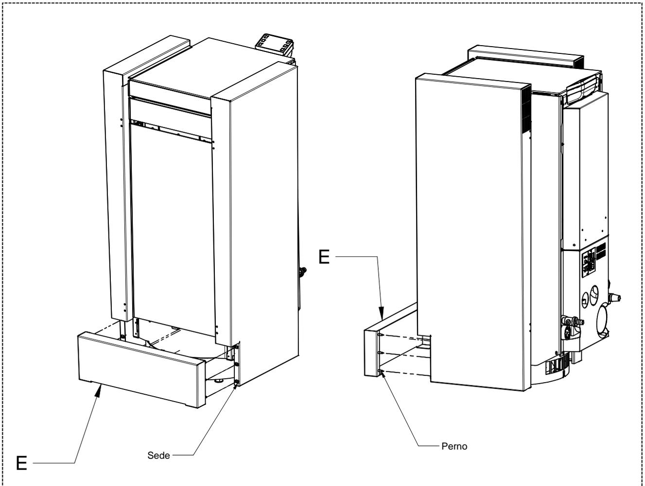
8 – Monte el perfil inferior (E) encajando las clavijas (Perno) en los alojamientos (Sede) correspondientes. Se aconseja encajar primero las 3 clavijas de un lado, y después las 3 clavijas del otro lado.
