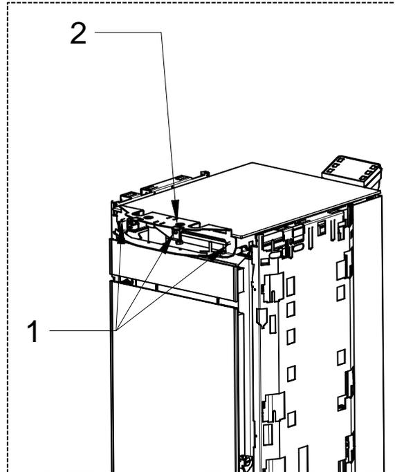
2 – Desenrosque los 3 tornillos (1) que fijan el soporte delantero (2). Eliminar el soporte (2).
