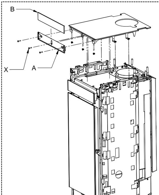
3 – Fije el soporte del cristal (A) al equipo con los tornillos (X) suministrados en el kit. Luego, introduzca el cristal (B) en el soporte del cristal (A). Al fin, vuelva a colocar la tapa superior (M).
