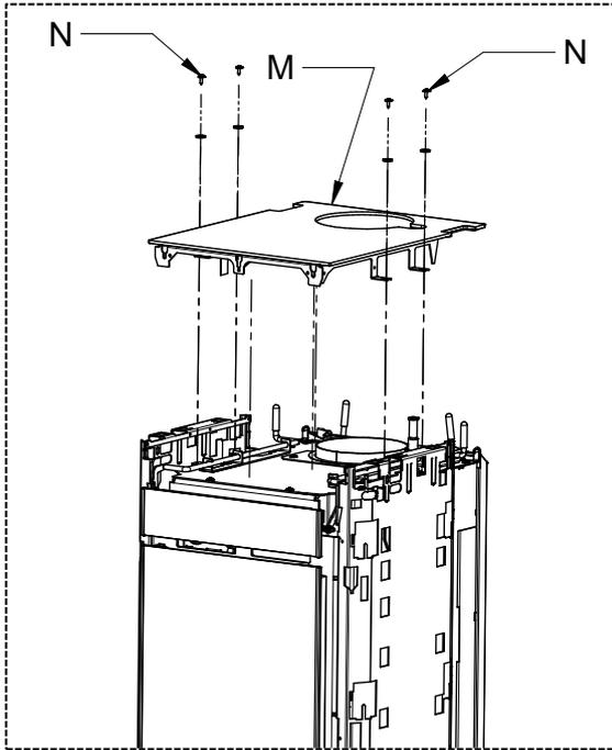
1 – Retire la tapa superior (M) desenroscando los 4 tornillos (N).
