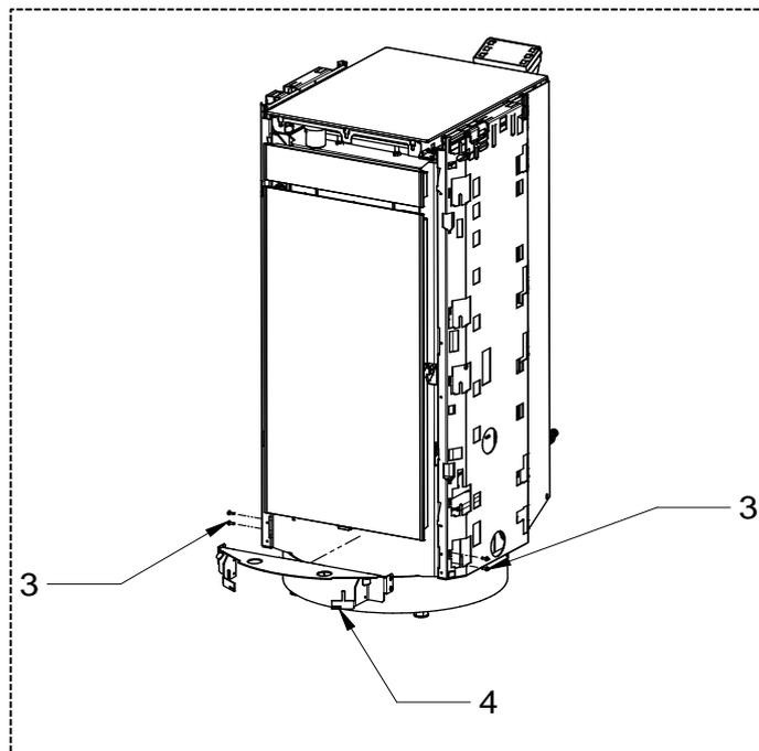
5 – Desenrosque los 4 tornillos (3) que fijan el soporte inferior (4). Eliminar el soporte (4).
