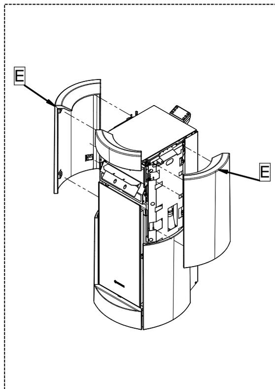
5 - Enganche el lateral superior (E) en los dientes correspondientes, como se hizo anteriormente. Deforme ligeramente los dientes con el fin de fijar firmemente la mayólica al cuerpo. Siga el mismo procedimiento en el lateral opuesto.
