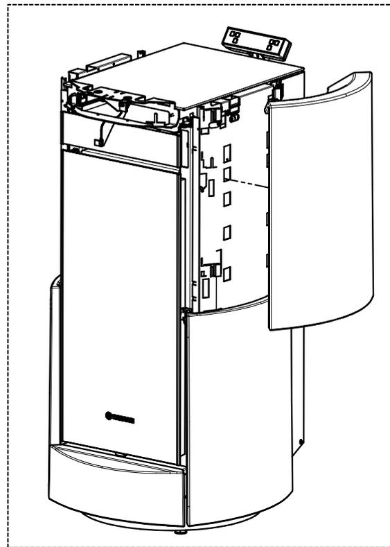
6 - Enganche el lateral superior (C) en los dientes correspondientes, como se hizo anteriormente. Deforme ligeramente los dientes con el fin de fijar firmemente la mayólica al cuerpo. Siga el mismo procedimiento en el lateral opuesto.
