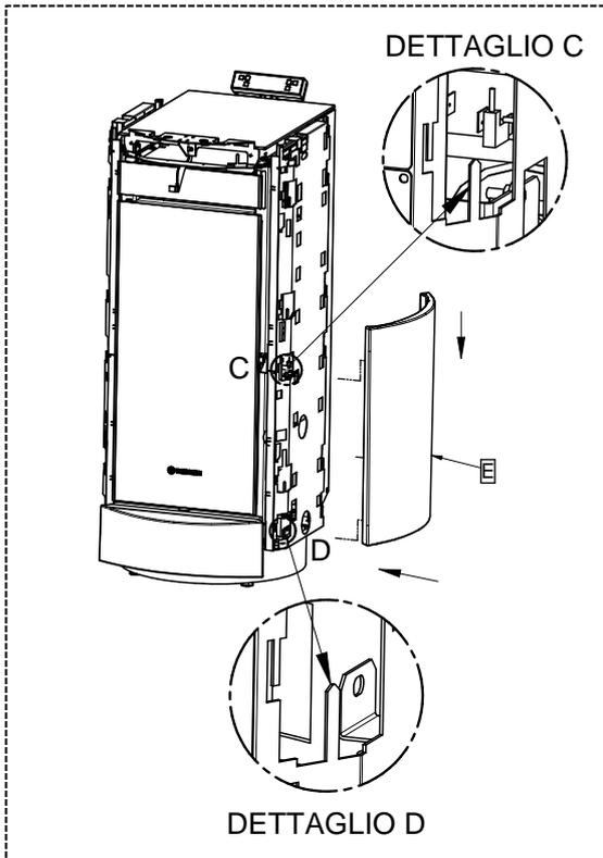
5 - Enganche el lateral inferior (E) en los dientes correspondientes, como se muestra en los detalles C y D. Deforme ligeramente los dientes con el fin de fijar firmemente la mayólica al cuerpo. Siga el mismo procedimiento en el lateral opuesto.
