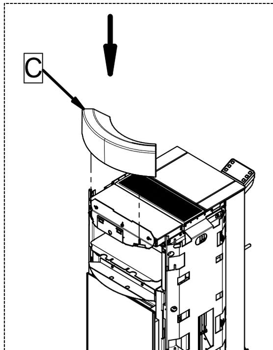
3 - Enganche la mayólica superior (C) en los dientes correspondientes. Deforme ligeramente los dientes con el fin de fijar firmemente la mayólica al cuerpo.
