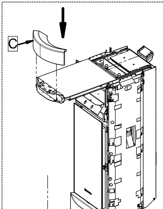
2 - Extraiga la bandeja e introduzca la mayólica superior (C) en los dientes correspondientes. Deforme ligeramente los dientes con el fin de fijar firmemente la mayólica al cuerpo.
