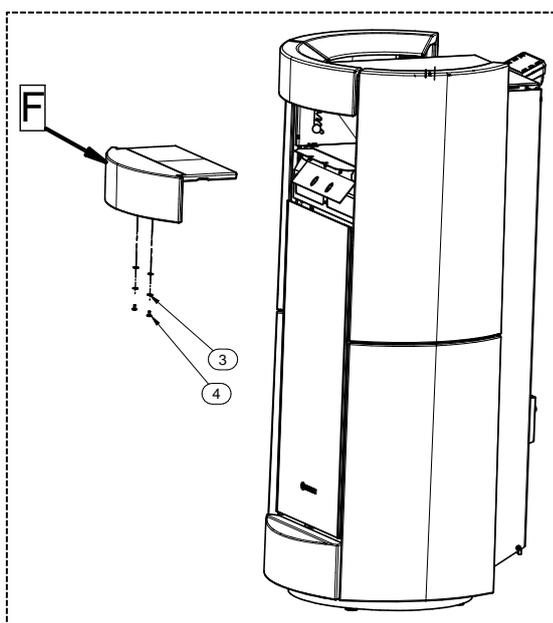
6 - Solo para los productos de aire, introduzca la mayólica central (F) tal como se muestra en la figura. A continuación, fíjela con los tornillos (4) y las arandelas (3).
