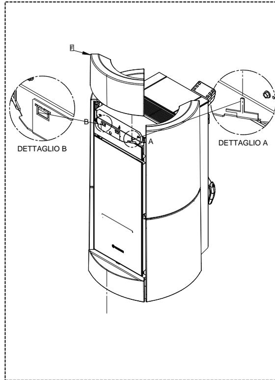
8 - Enganche la mayólica superior (F) en los dientes correspondientes. Deforme ligeramente los dientes con el fin de fijar firmemente la mayólica al cuerpo.
