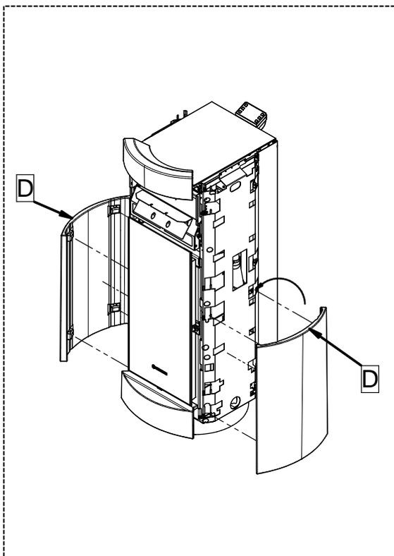
4 - Enganche el lateral inferior (D) en los dientes correspondientes. Deforme ligeramente los dientes con el fin de fijar firmemente la mayólica al cuerpo. Siga el mismo procedimiento en el lateral opuesto.
