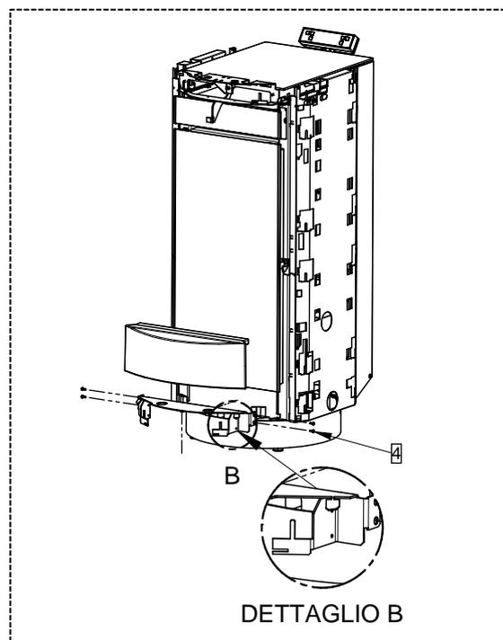
4 - Regule los dos dientes indicados en el DETALLE B, con el fin de fijar firmemente la mayólica al estribo. Por último, fije el estribo con la mayólica, utilizando los 4 tornillos (4) previamente quitados.
