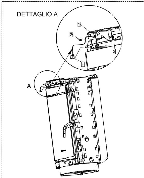
1 - Fije el estribo de soporte (H) al orificio (3) con el tornillo (1) y la tuerca (2).
