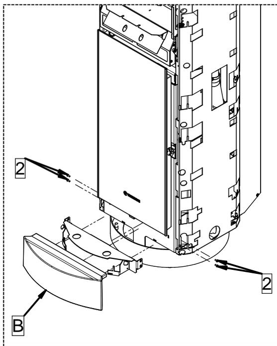
1 - Desenrosque los 4 tornillos (2) y quite el estribo de soporte de la mayólica. Coloque la mayólica inferior (B) en el estribo recién quitado. Por último, fije el estribo con la mayólica, utilizando los 4 tornillos (2) recién quitados.
