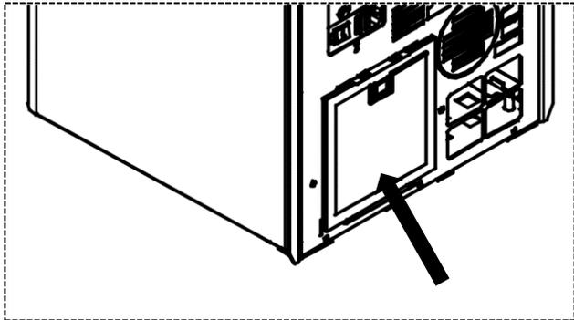
Diese praktische Vorrichtung verhindert, dass Staub, der in jedem Haushalt vorkommt, in den Kreislauf gerät. Der Filter befindet sich im hinteren Teil des Gerätes. Durch seine häufigere Reinigung wird sichergestellt, dass während des Betriebs mehr Heißluft bereitgestellt wird (der Filter muss alle 5 Tage mit kaltem Wasser ausgewaschen und getrocknet werden).
