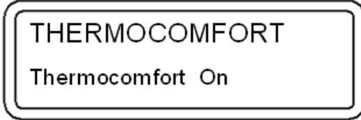
**ACHTUNG:** Die Funktion THERMOCOMFORT kann nur aktiviert und ON auf der vorherigen Bildschirmseite nur ausgewählt werden, wenn das Gerät das Signal der Fernbedienung erfasst. Es sollte kontrolliert werden, dass die Fernbedienung eingeschaltet ist und sich neben dem Gerät befindet.
