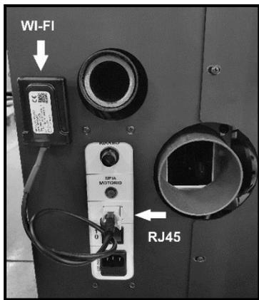
Apague la unidad con el interruptor 0/I. Después de apagarlo, enchufe el cable del módulo Wi-Fi en la toma RJ45 del panel de alimentación de la unidad, que normalmente se encuentra en la parte posterior de la unidad (consulte el manual de uso y mantenimiento del producto). Ahora enciende la unidad de nuevo. Conecte el módulo Wi-Fi a la parte trasera de la unidad usando la pegatina de velcro suministrada.
