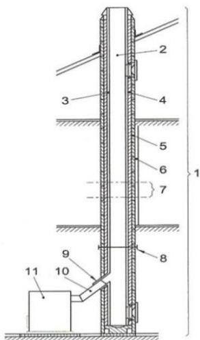
Cada chimenea debe estar compuesta al menos por los componentes previstos por la norma UNI EN 10683, indicados también en la figura de la izquierda.
