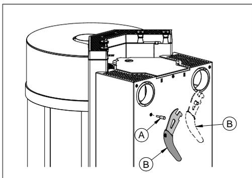
El equipo está dotado de una manija (B) que permite abrir y cerrar la puerta corredera de la cámara de combustión para realizar las operaciones de limpieza. Cuando no se utiliza, la manija se puede guardar en la parte posterior del equipo, en el gancho suministrado (A).
