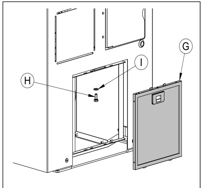
4) Quite el filtro (G) y fije el ventilador en la parte superior con el perno (H) y la arandela (I).
