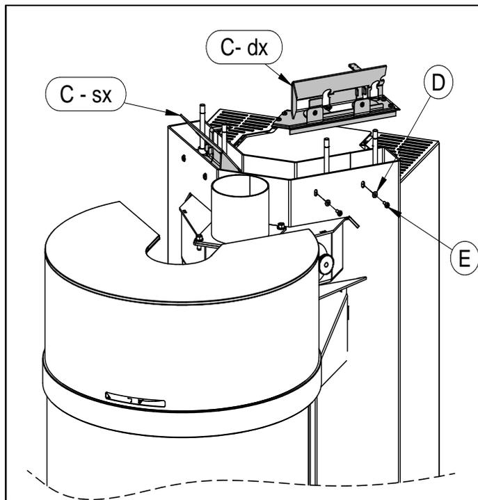
6) Coloque los deflectores (C - izq.) y (C - der.). Abra la puerta corredera de la cámara de combustión (a tal fin, consulte el capítulo correspondiente) y fije los dos deflectores con los 4 tornillos (E) y las 4 arandelas (D). A continuación, coloque la tapa de hierro fundido (B).
