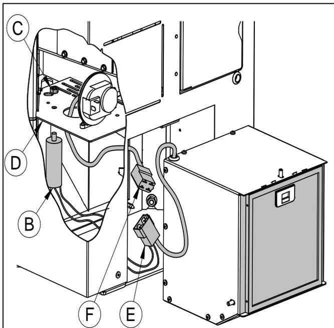
3) Introduzca el condensador (B) en el orificio correspondiente, fíjelo con el perno (C) y conecte el conector (E) con el conector (F). Por último, empuje el ventilador hacia el interior hasta el fondo.
