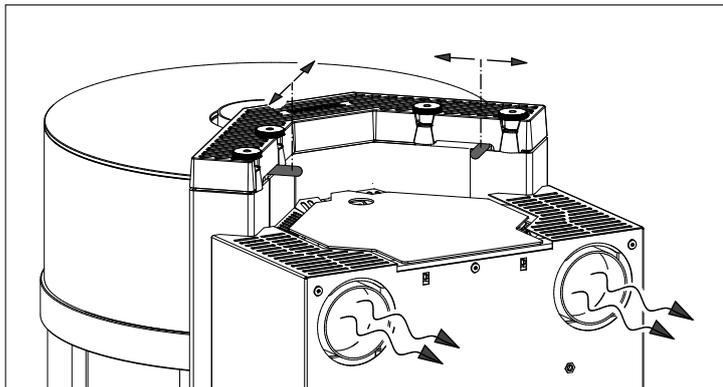
**ATENCIÓN:** La temperatura de las palancas de canalización durante el funcionamiento es muy elevada: preste atención para no tocarlas. Se deben accionar exclusivamente con la manija suministrada. Si las canalizaciones no están entubadas, es obligatorio verificar que en la parte posterior del equipo no haya objetos y/o materiales que se puedan dañar con el calor en caso de una posición errónea de las palancas de canalización.
