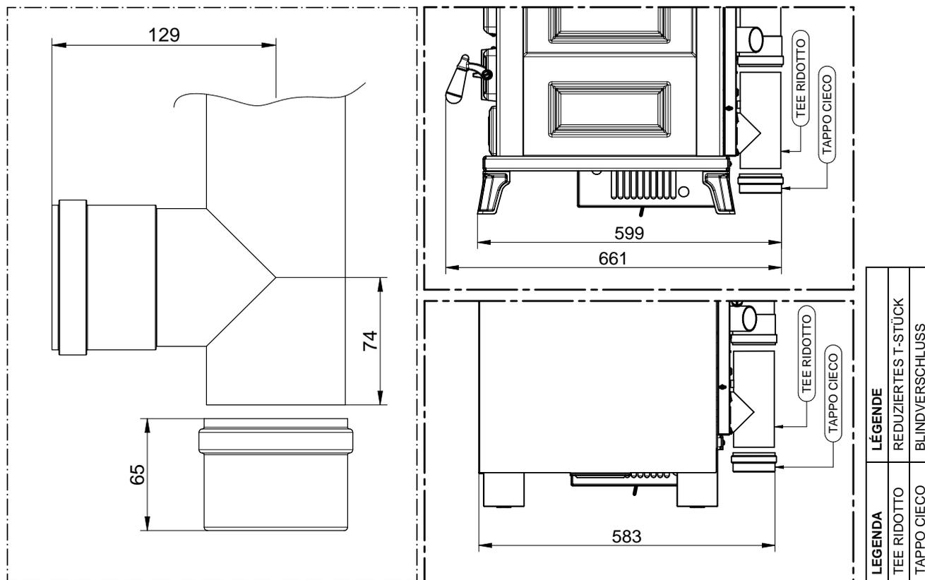
**ACHTUNG:** Besonders zu achten ist auf den Zusammenbau des Rauchabzugsrohres, weil dieses mindestens 24 mm vom Bedienfeld entfernt sein muss. Die Montage des Rohres in der Nähe des Bedienfeldes bedeutet dessen Schädigung durch Überhitzung (dieser Schaden ist nicht durch die Gewährleistung abgedeckt).
