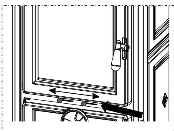
Regula el flujo de aire secundario que, al pasar por los orificios de la parte posterior de la cámara de combustión y precalentarse, favorece el encendido de la segunda combustión. Al mover una de las dos palancas hacia la izquierda se reduce el flujo de aire. Por el contrario, si se desplaza hacia la derecha, aumenta el flujo de aire.
