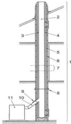
Cada chimenea debe estar formada, como mínimo, por los componentes dispuestos por la norma UNI EN 1443 que también se muestran en la figura de al lado.
