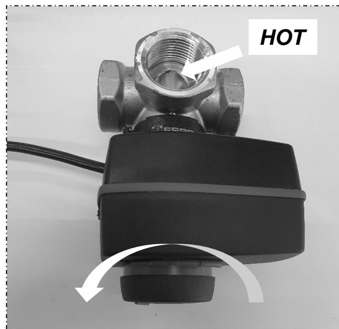
**7** – Per verificare se l'installazione è andata a buon fine ruotare il tappo estratto in senso antiorario fino a fine corsa. Se il ramo HOT risulta completamente chiuso l'installazione è andata a buon fine, altrimenti si consiglia di ricominciare dall'inizio la procedura.
