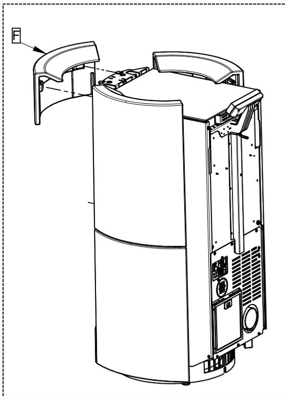
8 - Infilare la maiolica superiore (F) negli appositi dentini. Deformare leggermente i dentini in modo da rendere solidale la maiolica al corpo.
