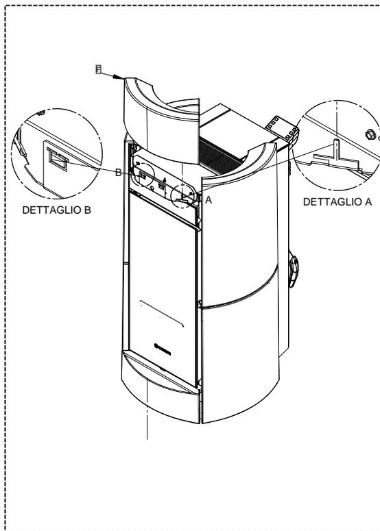
9 - Infilare la maiolica superiore (F) negli appositi dentini. Deformare leggermente i dentini in modo da rendere solidale la maiolica al corpo.
