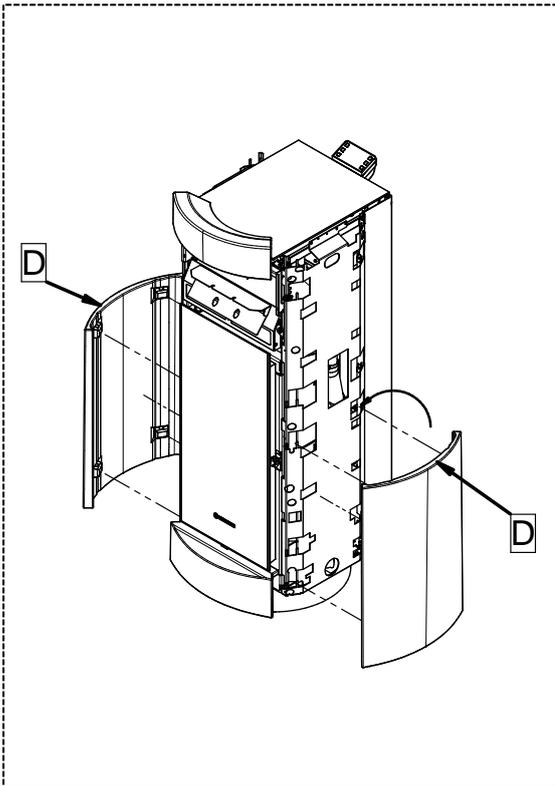
4 - Infilare il fianco inferiore (D) negli appositi dentini. Deformare leggermente i dentini in modo da rendere solidale la maiolica al corpo. Eseguire la stessa procedura sul fianco opposto.
