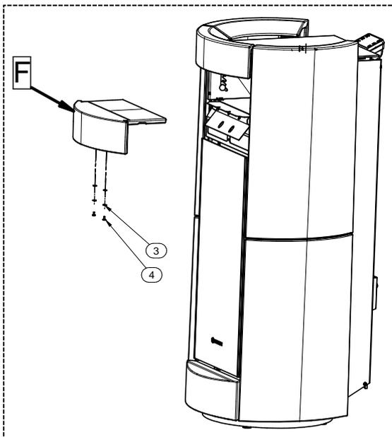
6 – Solo per i prodotti ad aria, infilare la maiolica centrale (F) come indicato in figura. Fissarla poi con le viti (4) e le rondelle (3).
