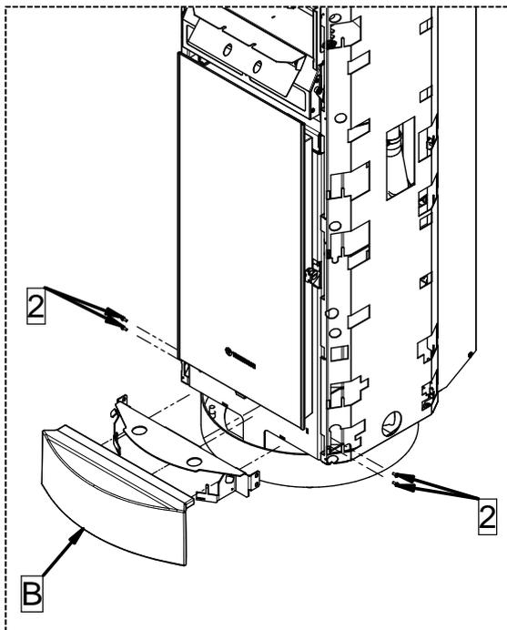
1 - Svitare le 4 viti (2) e rimuovere la staffa sorreggi maiolica. Infilare la maiolica inferiore (B) sulla staffa appena rimossa. Al termine fissare la staffa completa di maiolica con le 4 viti (2) appena rimosse.
