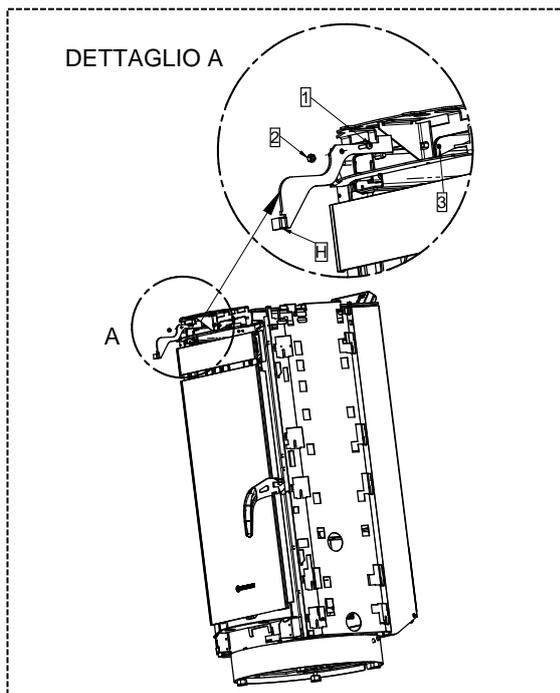
1 - Fissare la staffa di supporto (H) al foro (3) attraverso la vite (1) e il dado (2).
