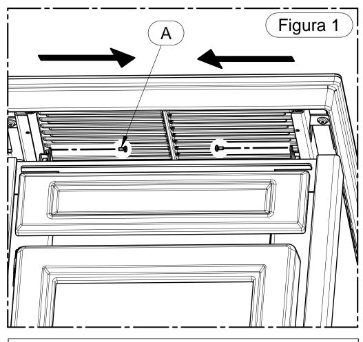
1 – Die beiden Feststeller (A) entfernen, die die Gleitschale blockieren.
