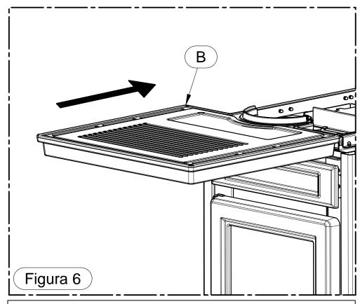
6 – Die zuvor entfernte Gleitschale (B) einsetzen.
