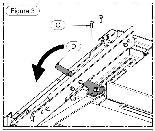
3 – Die Schrauben C ausdrehen und den Luftregelungshebel D entnehmen.
