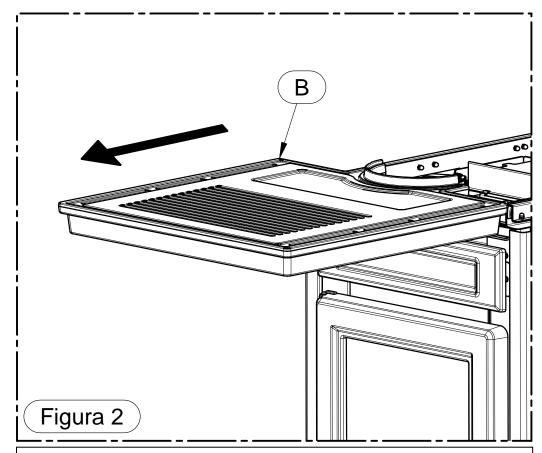
2 – Die Gleitschale entfernen, indem man sie bis zum Ende herauszieht.
