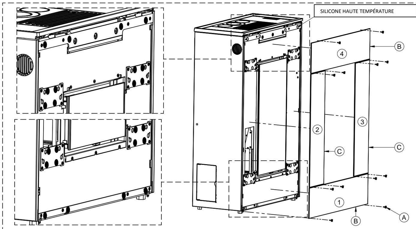
Pour coller les vitres ou le grès, siliconer la surface de la partie antérieure comme indiqué dans la figure ci-dessus. Veiller à ne pas siliconer les zones d'intersection des bords. Sinon, le silicone pourrait déborder et compromettre l'esthétique du produit.
