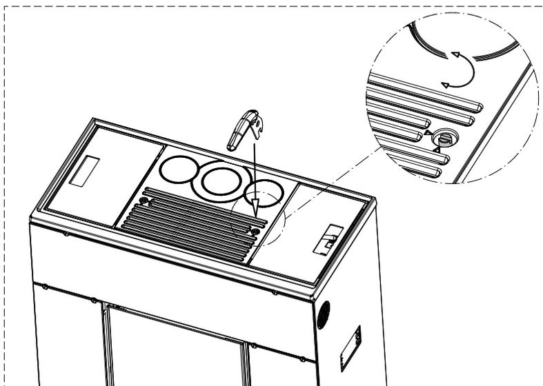
On peut choisir de diriger le flux d'air dans la canalisation latérale ou arrière/supérieure en tournant le levier illustré dans la figure ci-dessus. Le flux sortira dans la direction indiquée par la flèche.
