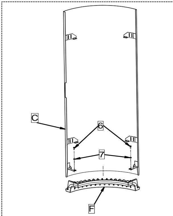
5 - Mit den zum Lieferumfang des Bausatzes gehörenden Schrauben (6) und den Unterlegscheiben (7) das seitliche Eisengussteil oben (F) an der Seitenwand (C) befestigen. Bei der gegenüberliegenden Seitenwand genau so vorgehen.
