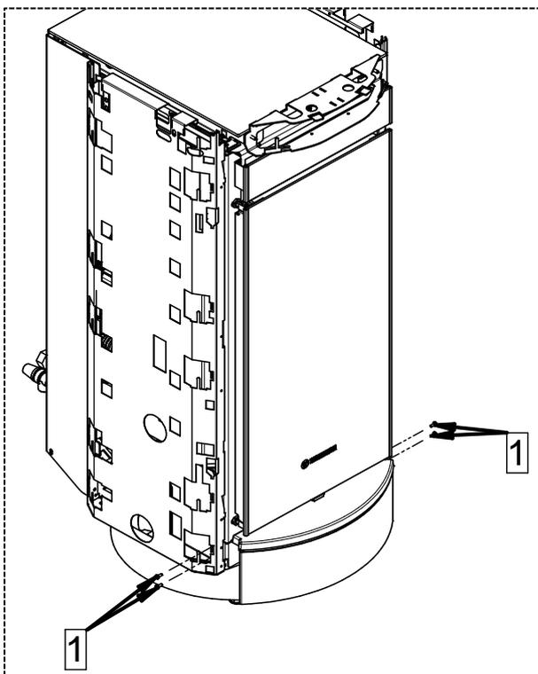
4 - Die so entstandene Baugruppe mit den zuvor entfernten Schrauben (1) am Gerät befestigen.
