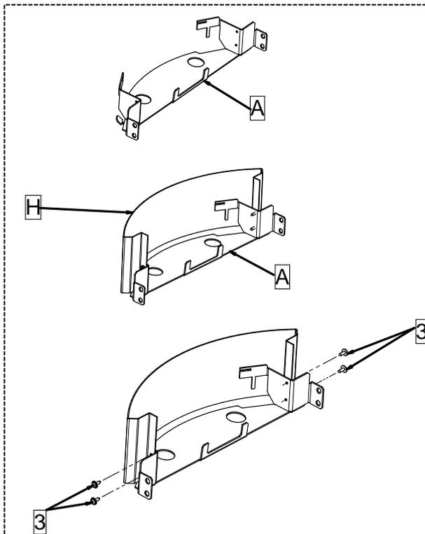
2 - Befestigen Sie das kalandrierte Profil (H) mit den vier Schrauben (3) aus dem Bausatz an der soeben entfernten unteren Halterung (2).
