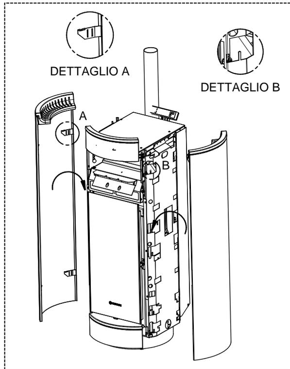
6 - Die so entstandene Seitenwand in die entsprechenden Zähnnchen einsetzen, die sich am Gerät befinden (siehe Details). Bei der gegenüberliegenden Seitenwand genau so vorgehen.
