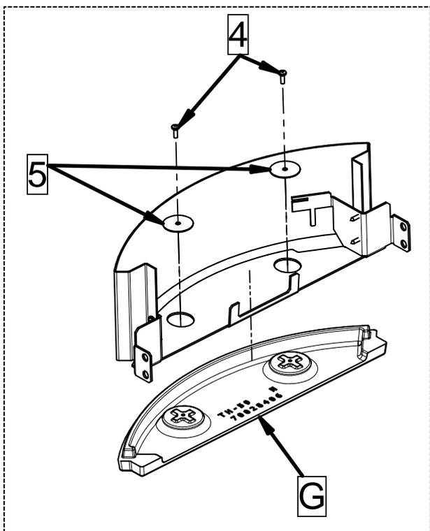
3 - Das untere Eisengussteil (G) mit den 2 Schrauben (4) und den 2 Unterlegscheiben (5) am soeben angefügten unteren Bügel (A) befestigen.
