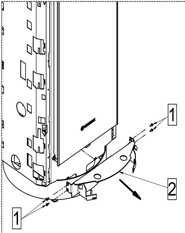
1 - Die 4 Schrauben (1) ausdrehen und den am Gerät sitzenden unteren Bügel (2) abnehmen.
