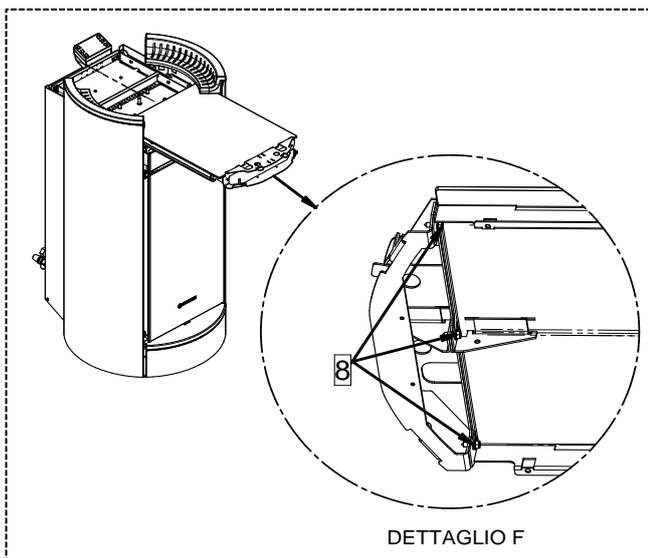
7 - Das Tablett für die Pelletzufuhr entnehmen und die unten befindlichen 3 Schrauben (8) lockern, wie aus dem Detail ersichtlich.
