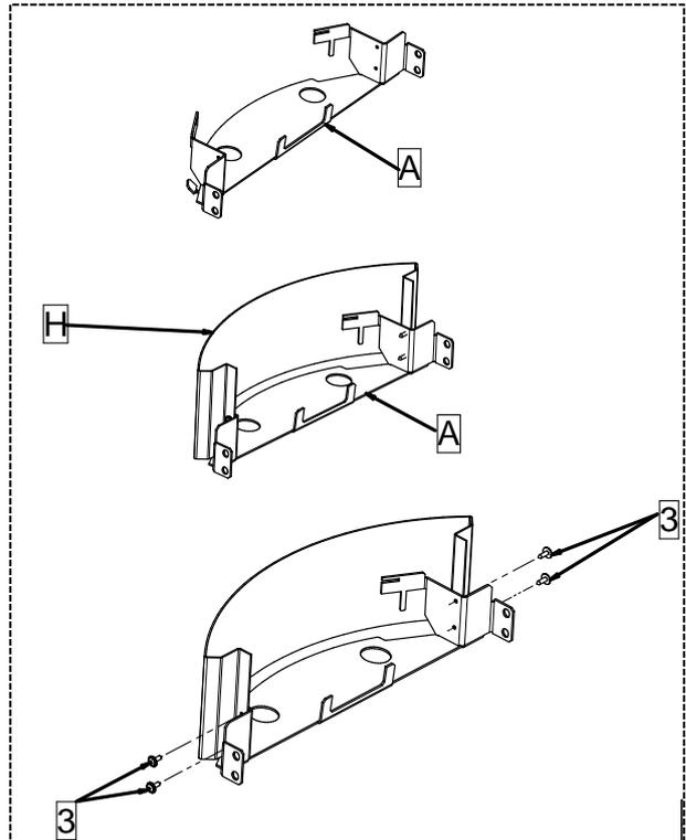
2 - Befestigen Sie das kalandrierte Profil (H) mit den vier Schrauben (3) aus dem Bausatz an der soeben entfernten unteren Halterung (2).
