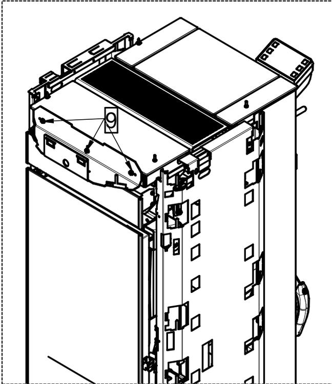
9 - Die 3 Schrauben (9) lockern, die sich im oberen Teil des Gerätes befinden.
