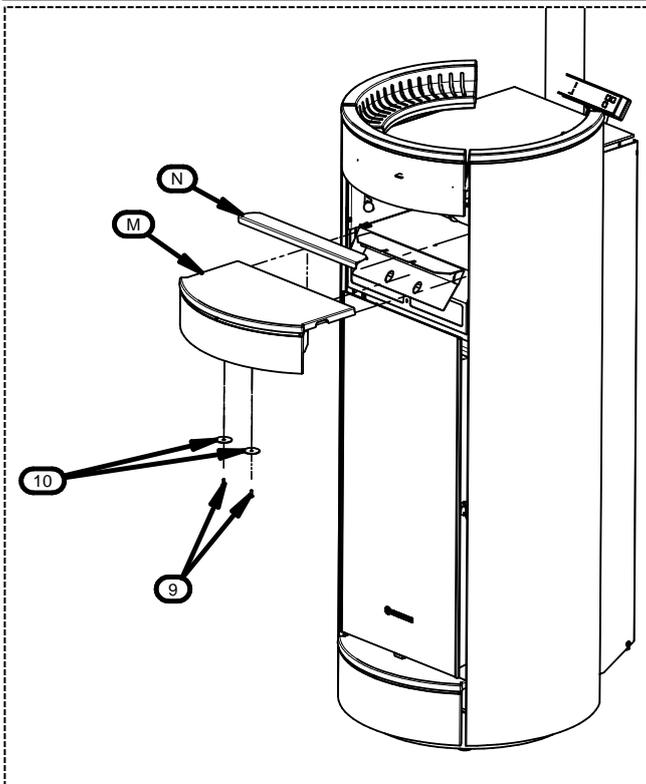
11 - Die gusseiserne Kleinofenfläche (M) mit den Schrauben (9) und Unterlegscheiben (10) befestigen, wie in der Abbildung gezeigt. Das optisch ansprechende Profil (N) nur in das Modell PAIRPLUS 13 installieren.
