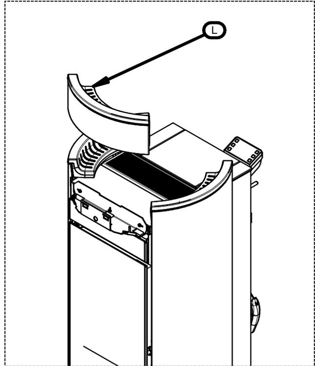
10 - Das mittlere Eisengussteil oben (L) in den entstandenen Zwischenraum einsetzen.
