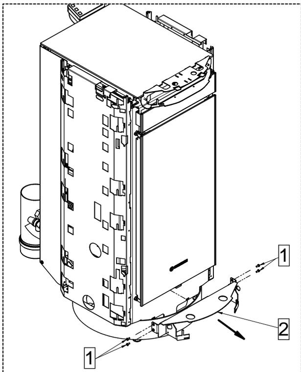
1 - Die 4 Schrauben (1) ausdrehen und den am Gerät sitzenden unteren Bügel (2) abnehmen.
