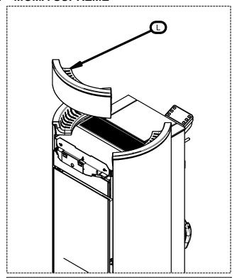
10 - Introduzca la pieza de hierro fundido superior central (L) en la cámara intermedia creada.
