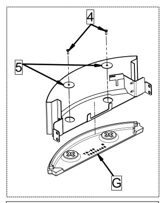
3 - Fije la pieza de hierro fundido inferior (G) al estribo inferior (2 - A) recién ensamblado con los 2 tornillos (4) y las 2 arandelas (5).
