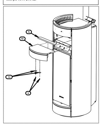
11 - Fije el hierro fundido del hornillo (M) con los tornillos
