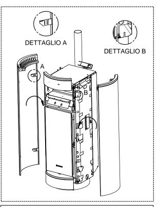
6 - Introduzca el lateral creado en los dientes correspondientes presentes en el equipo (véase el detalle). Realice la misma operación con el lateral opuesto.
