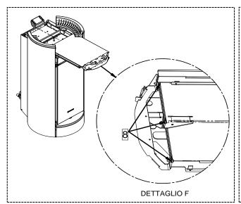
7 - Extraiga la bandeja de carga de pellets y afloje los 3 tornillos (8) presentes debajo, tal como se muestra en el detalle (F).
