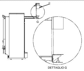
8 - Introduzca la pieza de hierro fundido superior central (L) en la cámara intermedia creada y, si es necesario, apriete los tornillos (8) previamente aflojados.
